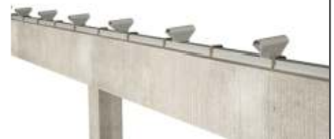
3) los bigotes se sueldan enlazando el perfil portacaballetes
