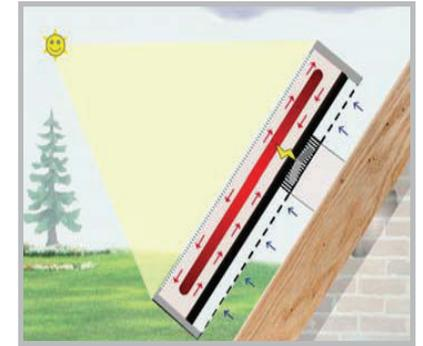
Detalle de la ubicación óptima de los colectores SolarVenti®.
